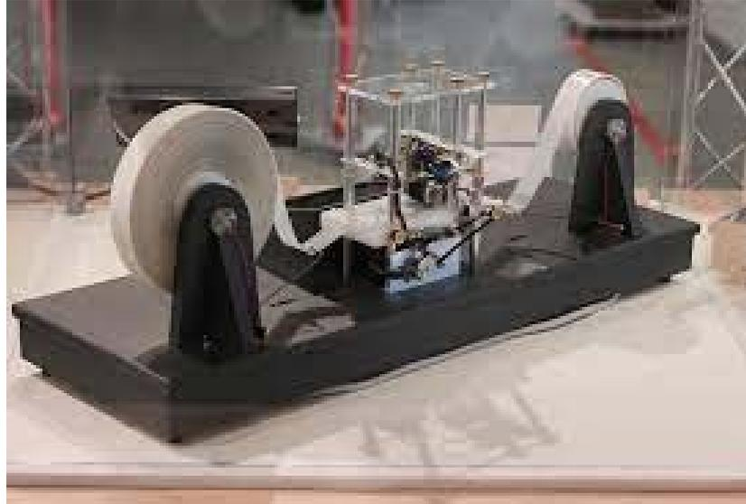
la macchina di Turing è formata da un'unità di controllo contenente un programma con un numero finito di istruzioni, da un nastro di lunghezza illimitata suddiviso in celle e da un'unità di lettura e scrittura sul nastro in grado di spostarsi avanti e indietro di un numero qualsiasi di celle e di leggere e scrivere in una qualsiasi delle celle un simbolo di un alfabeto prefissato.
